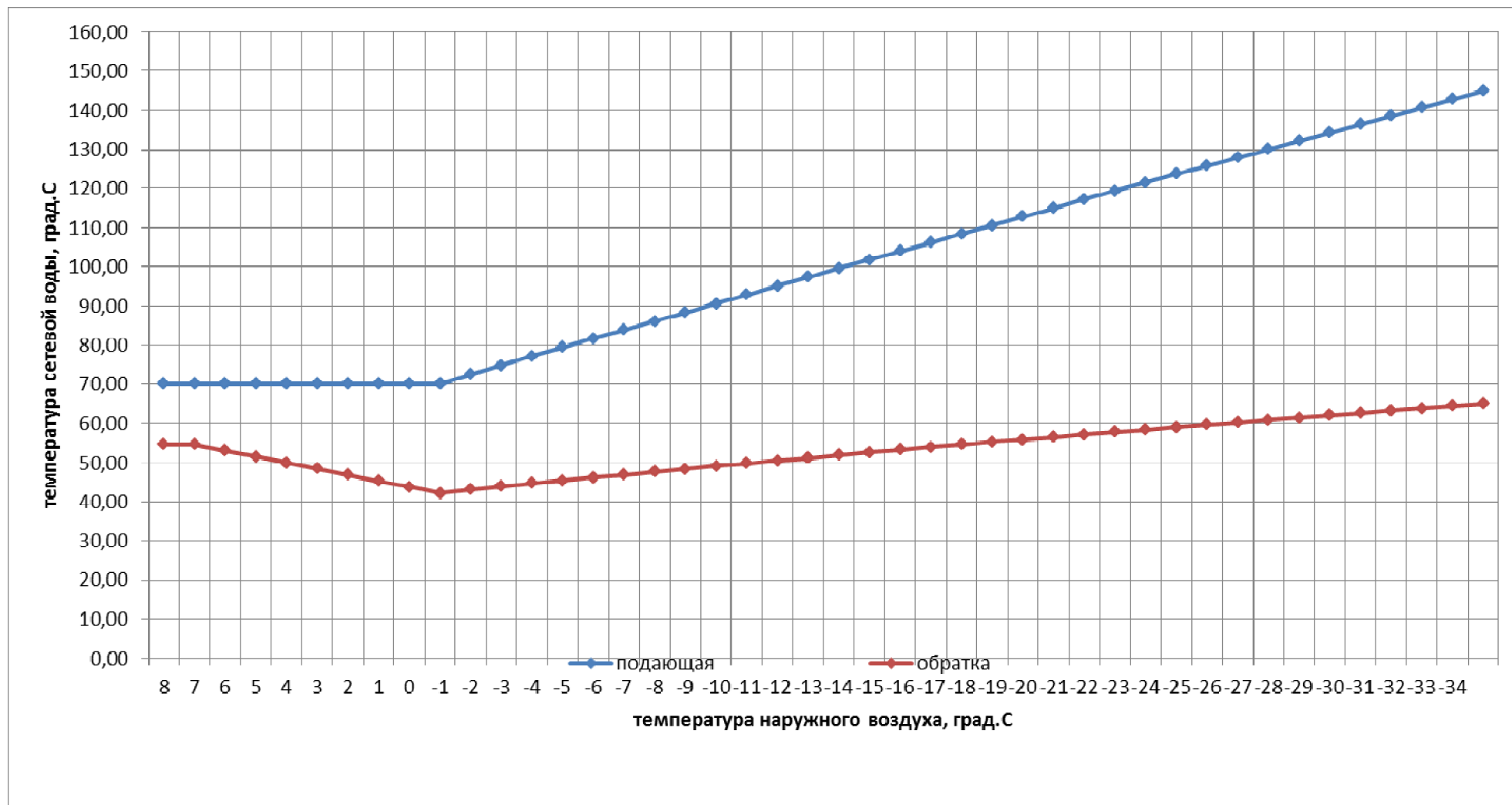
Рисунок 4-2. Оптимальный (расчетный) температурный график тепловой сети г.Набережные Челны для закрытой системы теплоснабжения
