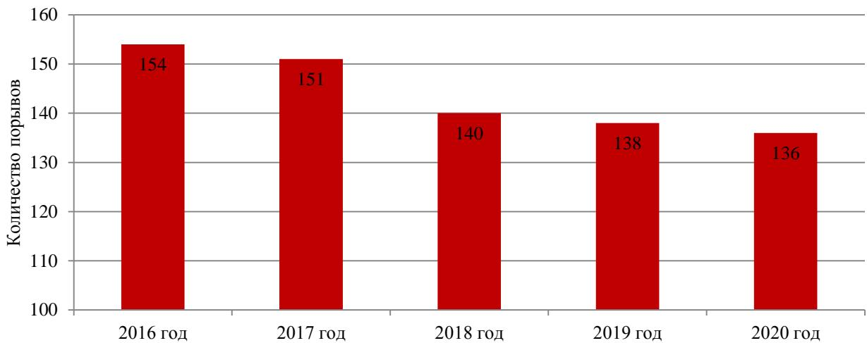
Снижение потерь воды при транспортировке и количества аварий связано с плановым проведением капитального ремонта водопроводных сетей с истёкшим сроком службы.
